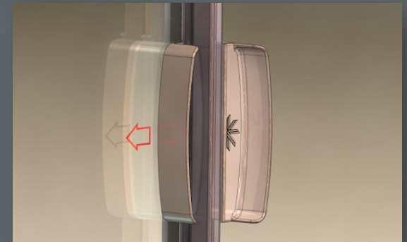
Poignées collées aux vitres extérieures
