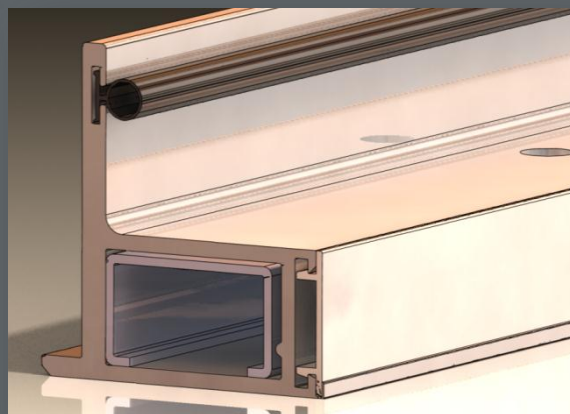
Sowohl der untere als auch der obere Träger sind aus PVC mit Stahlverstärkung.
